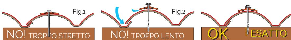
1) Se la vite è troppo stretta la lastra si curverà all'altezza del fissaggio con rischio di venature o rotture che comprometteranno l'integrità della copertura (Fig.1).
