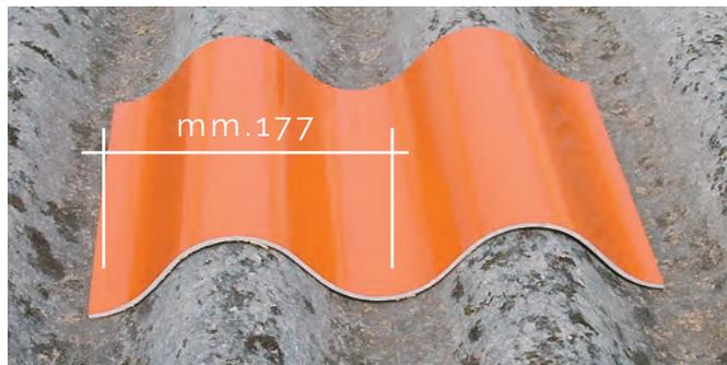
Onda Romana e Romana Egeo sono state progettate per sormontare perfettamente il profilo d'onda della lastra in cemento amianto; il tetto da bonificare potrà essere pertanto dapprima trattato con sostanze impregnanti di natura sintetica, che ingloberanno le pericolose fibre d'amianto e ne impediranno il rilascio, ed in seguito verrà effettuata la sovra-copertura con il prodotto Cover-Life che, fungendo da elemento "ricoprente", consentirà di ottenere una bonifica per incapsulamento.
