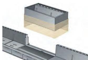
La fasciatura intorno al pozzetto servirà ad evitare la cementazione del pozzetto stesso che ne impedirebbe l'estrazione per l'ispezione.
