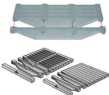
I traversini si fissano fra loro in modo molto semplice, occorre solo allineare il doppio sistema maschio/femmina e chiudere gli elementi che, una volta uniti, costituiranno un singolo pezzo (vedi immagine a sinistra).
