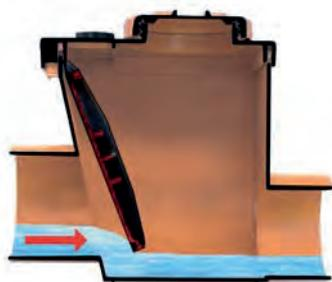
Le valvole di non ritorno sono dispositivi di anti-allagamento che si chiudono automaticamente quando si verifica un riflusso dalla rete fognaria e consentono lo scarico normale quando il riflusso cessa. L'installazione è possibile in sistemi di scarico di acque reflue funzionanti a gravità, all'interno ed esterno degli edifici ad uso residenziale, commerciale, industriale ed istituzionale.
