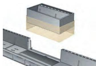
La fasciatura intorno al pozzetto servirà ad evitare la cementazione del pozzetto stesso che ne impedirebbe l'estrazione per l'ispezione.
