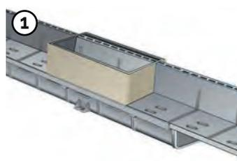
1 Appoggiare il pozzetto ispezione caditoia (cod. PICF) sul canale, a fianco del profilo caditoia a fessura (cod. PCF). Posizionare intorno ai bordi del pozzetto una fasciatura (telaio), a perdere, di materiale sufficientemente rigido (plastica, legno o metallo) di spessore circa 1 mm.
